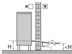
Lorsque l'eau est stationnaire dans le système, il y a un risque de gel, qui pourrait provoquer l'endommagement du système.
